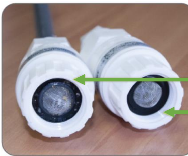
5. Sprawdź sitko. Przetrzeć palcem i wypłukać wodą jeśli widać zanieczyszczenia.
