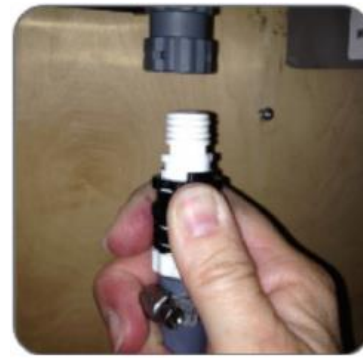
3. Odłącz wąż z „Flow jet” od kartridża
